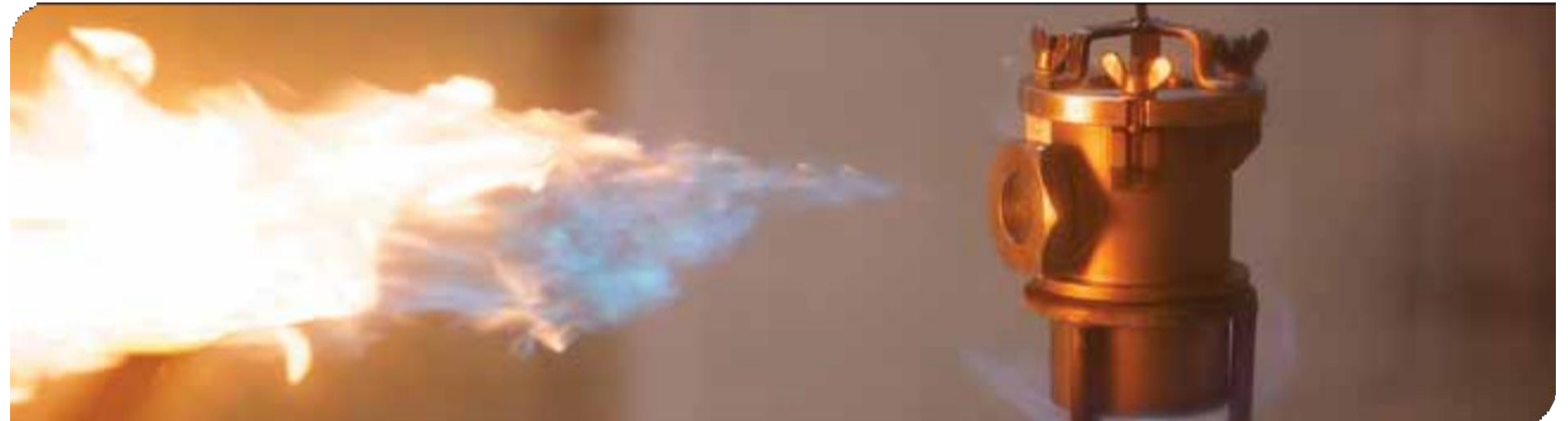
Pruebas de seguridad para determinar la sensibilidad de los peróxidos al efecto del calor en confinamiento
